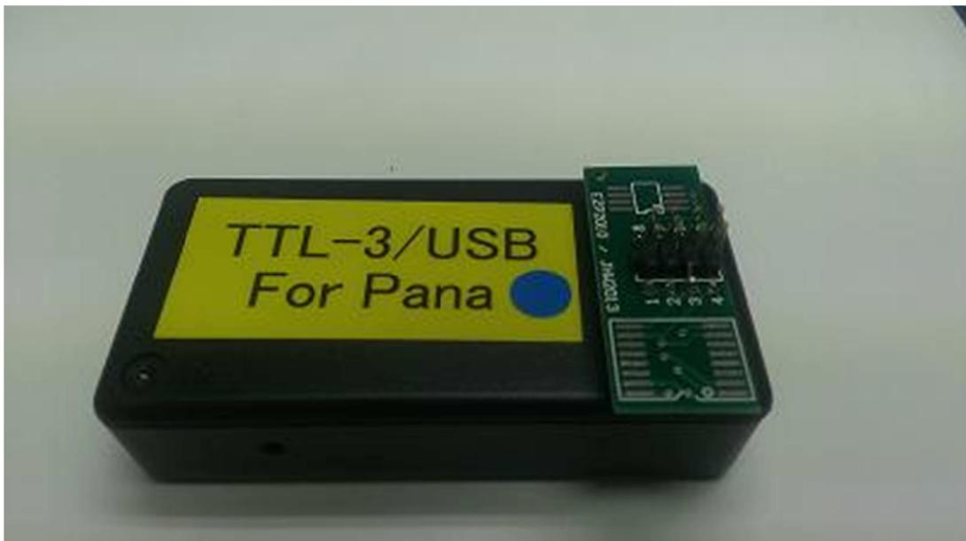
上記図のように SOP クリップ変換基盤を取り付けます。
